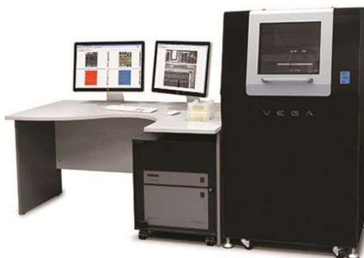
Рис.4. Сканирующий зондовый микроскоп ВЕГА, на столе пластина диаметром 200 мм (слева) и набор образцов.
